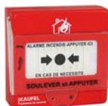
Les DM seront installer à proximité des sorties et à 1,30m du sol. La distance conseillée entre 2 déclencheurs doit être au maximum de 20 mètres.
