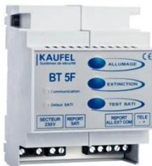
Elle sera réalisée par une télécommande sans polarité et assurera la mise au repos et le ré-allumage à distance, jusqu'à 500 blocs, conformément à la réglementation et permettra d'effectuer les tests des blocs Pair / Impair. Elle devra également disposer d'une fonction « Test SATI » vérifiant, en une seule action, depuis cette télécommande, l'état de l'ensemble des blocs autonomes.
